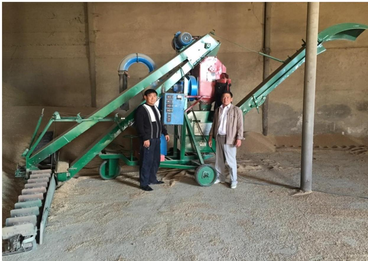
Рис.2. Общий вид зернометателя-классификатора.
