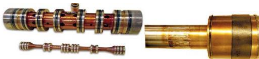
Рис.1. Лаковые отложения на золотниках сервоклапанов [2,3].
