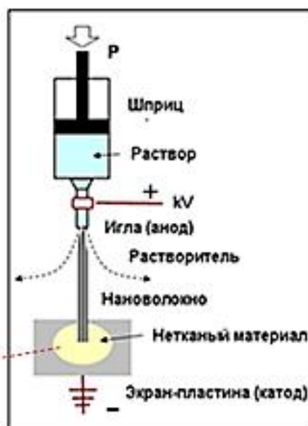
Рис. 1. Схема электроспиннинга нановолокон из раствора
