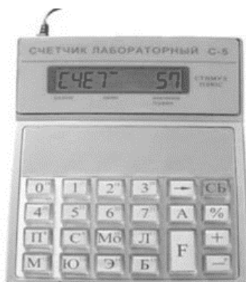
Рисунок 1 - Внешний вид счетчика лейкоцитарной формулы С-5
