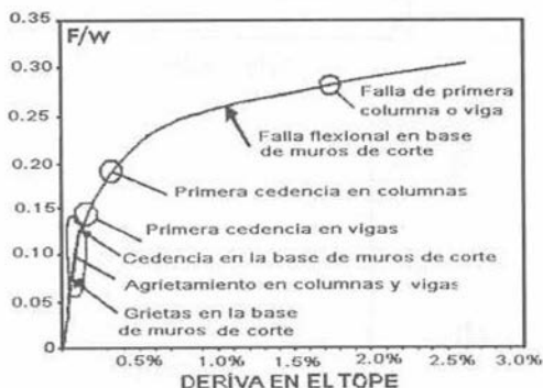
Fig. 5. Puntos Críticos en curva de capacidad (Reinhorn, 1977)
