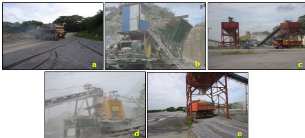
Figura 1. Procesos de generación de polvo. (ENIA, 2017) Leyenda: (a) Acarreo de materia prima; (b) Tolva de entrada y molino primario; (c) Molino secundario; (d) Zaranda; (e) Descarga de tolva almacenadora.
