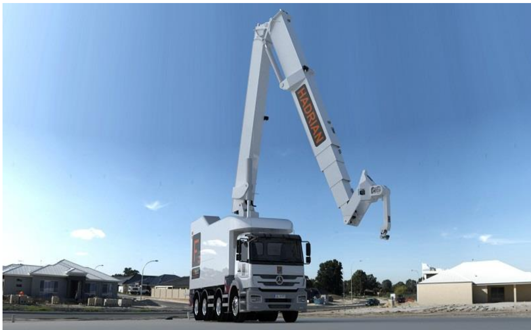
Рисунок 1. Изображение установленного оборудования Hadrian X на автомобильное шасси грузовика ( https://www.designingbuildings.co.uk/wiki/Hadrian_X ).
