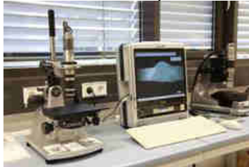
b) Digital Microscope (KEYENCE VHX-600)
