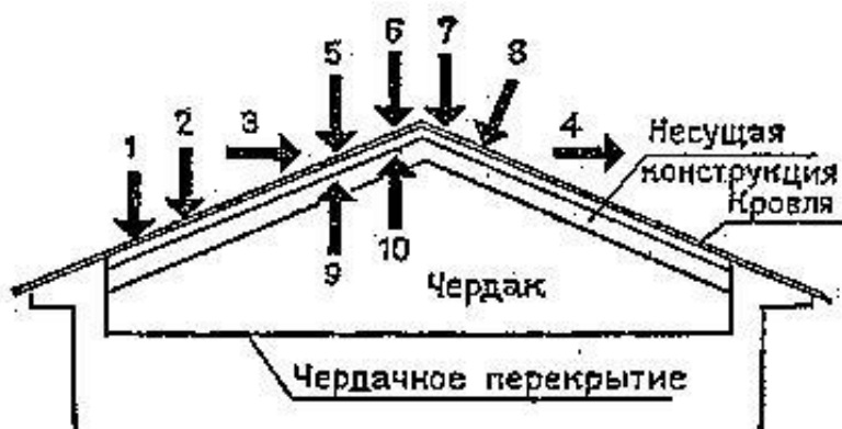
Рисунок. Воздействия на кровлю: 1 — инсоляция, 2 — град, 3 — ветровая нагрузка, 4 — отрицательное ветровое давление, 5 — дождь, 6 — снег, 7 — звуковая нагрузка, 8, 9 — водяной пар, 10 — вибрация
