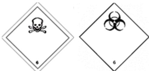
**Рис. 7.** Маркировка тары с токсичными и инфекционными веществами
