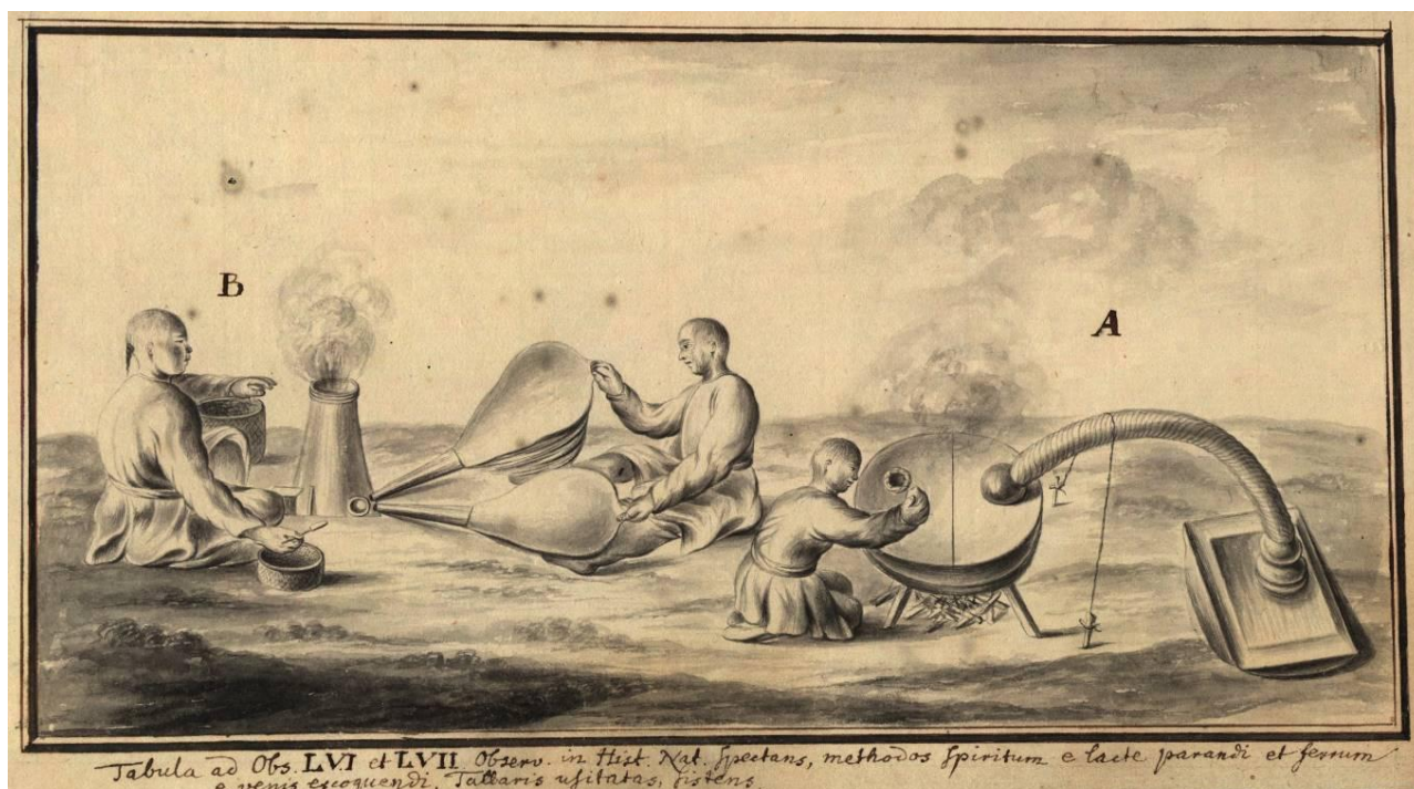
Рис. 1. Методы изготовления спирта из молока (А) и выплавки железа из руды (В) у кондомских татар, копия рисунка, выполненного И.В. Люрсениусом 19 сентября 1734 г. (РГАДА. Ф. 199. Оп. 2. П. 430. Д. 14. Л. 3)
