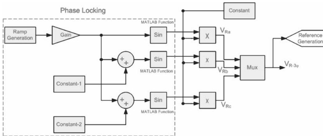
FIG. 3. BLOCK DIAGRAM REPRESENTATION OF REFERENCE VOLTAGE GENERATION
