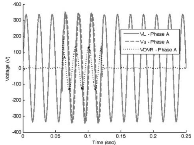
FIG. 23. DYNAMIC VOLTAGES FOR  $-25^\circ$  PHASE JUMP IN PHASE-A OF UTILITY VOLTAGE
