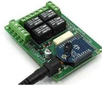
Gambar 6. Menghubungkan perangkat zigbee pada modul relai.
