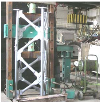
Рис. 3. Пространственный блок: a – общий вид при проведении испытаний; б – схема приложения узловой нагрузки
