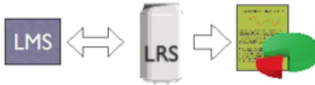
Fig. 4. Comunicación entre LMS y LRS (TinCan) para almacenamiento de registros de aprendizaje. Posterior uso por parte de, por ejemplo, herramienta de generación de informes.
