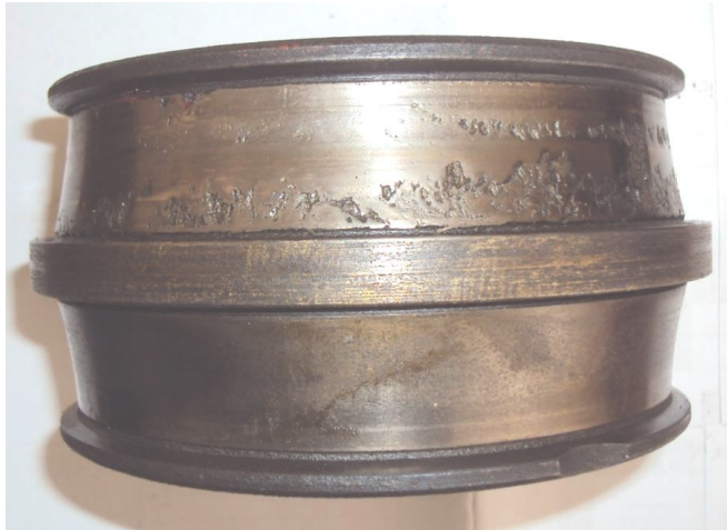
Рис. 2. – Неравномерный износ беговых дорожек внутреннего кольца подшипника 3 по рисунку 1
