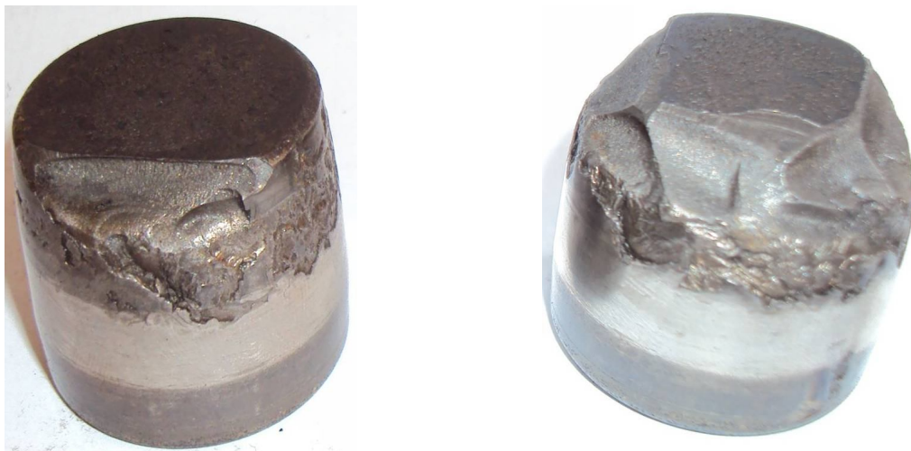
Рис. 3. – Дефектные ролики подшипника 3 по рисунку 1
