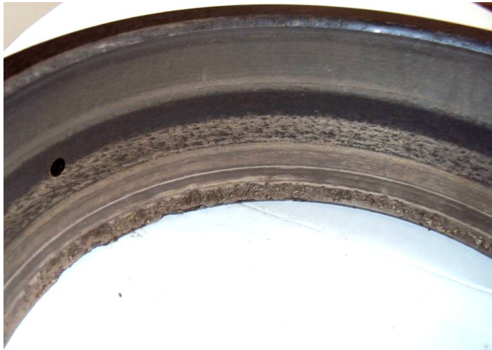
Рис. 4. – Повреждения наружного кольца
