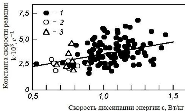
Рис. 4 – Влияние скорости диссипации энергии на величину константы скорости реакции при десульфурации природнолегированного чугуна: 1 – расход магния 0,058 – 0,066 кг/с, азота – 0,017 – 0,022 нм³/с; 2 – 0,033 кг/с и 0,017 – 0,022 нм³/с; 3 – 0,033 кг/с и 0,028 – 0,033 нм³/с
