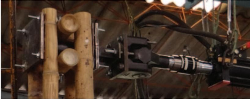
Figura 5. Dispositivo para la aplicación de carga
