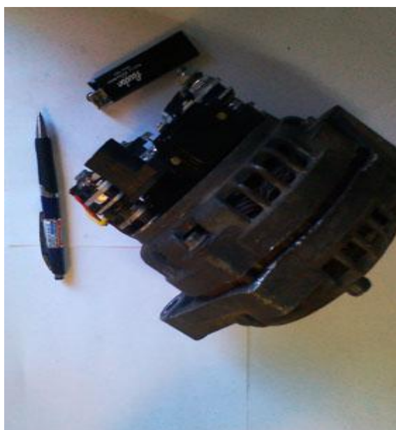
Рис.4. Опытная модель генератора с независимым включением фаз
