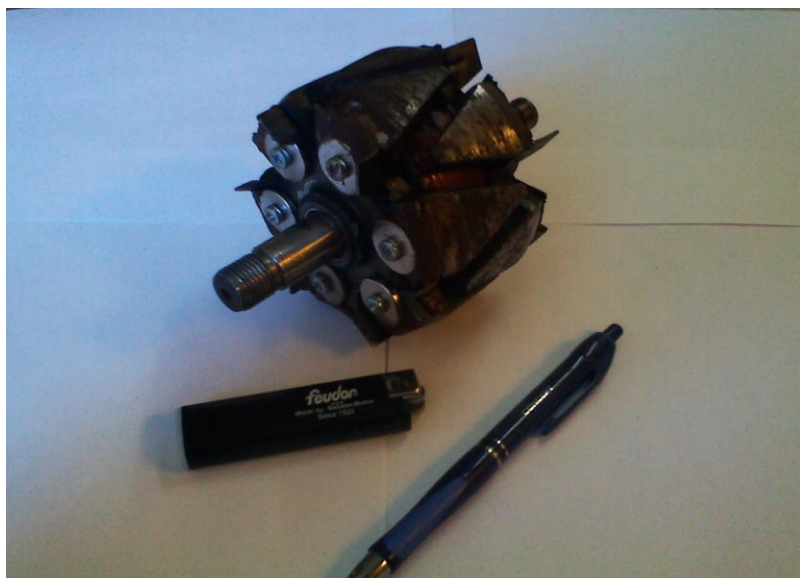
Рис.3. Модернизированный ротор синхронного генератора с независимым включением фаз
