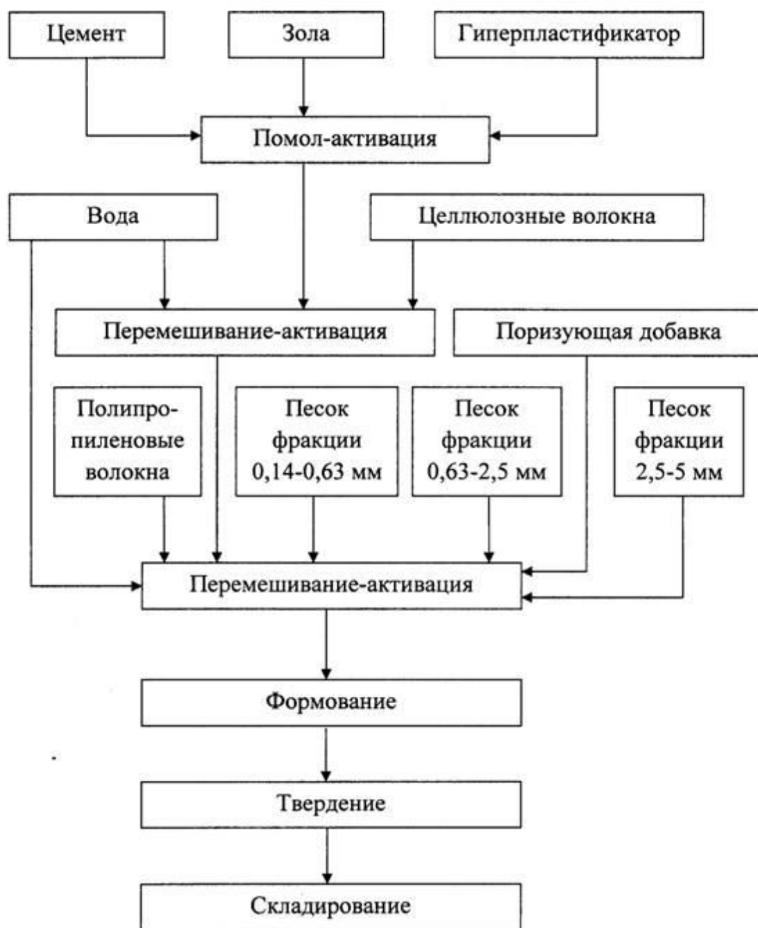
Рис. 1. Технологическая схема производства пористого фибробетона
