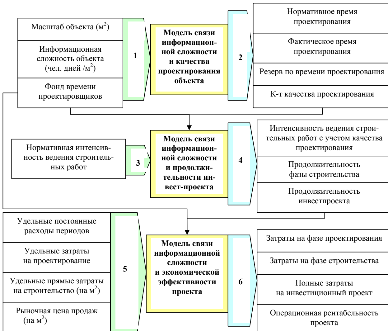
Рис. 2. Схема информационных связей между моделями расчета основных групп критериев операционной эффективности для предприятия в сфере девелопмента
