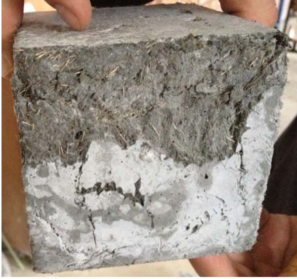
Şekil 3.1. Basınç numunelerine ait örnek kırılma şekli (Example for Compressive strenght test)
