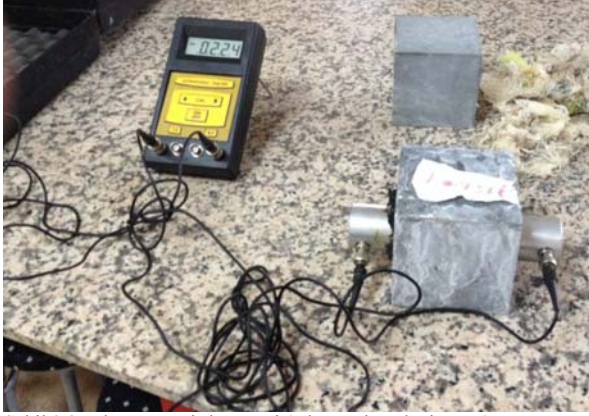
Şekil 2.3. Ultrases geçiş hızı testi (Ultrasonic velocity test)
