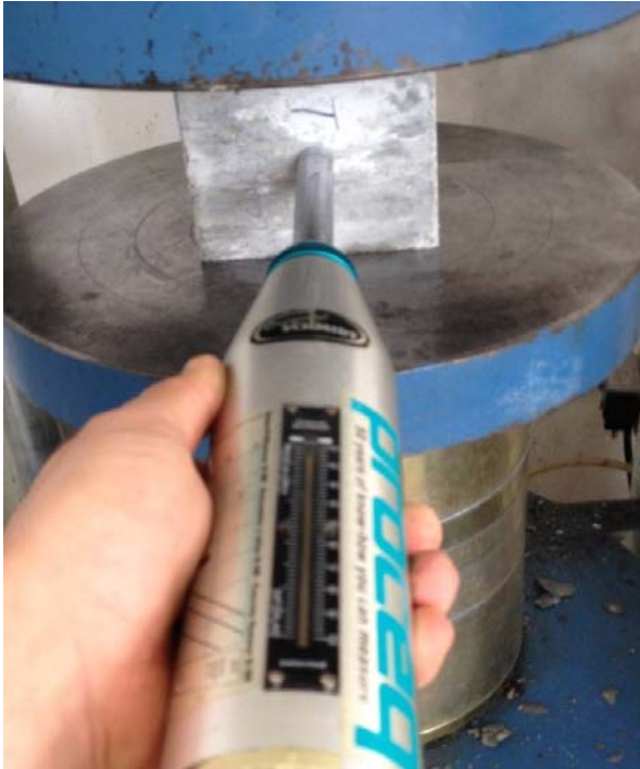
Şekil 2.4. Schmidt test çekici testi (Schmidt hammer test)
