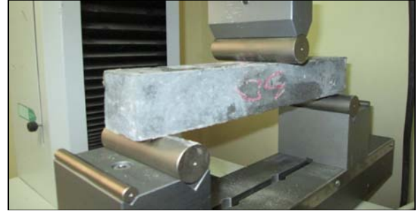
Şekil 2.6. Üç nokta eğilme deneyi (Three point flexure strength test)
