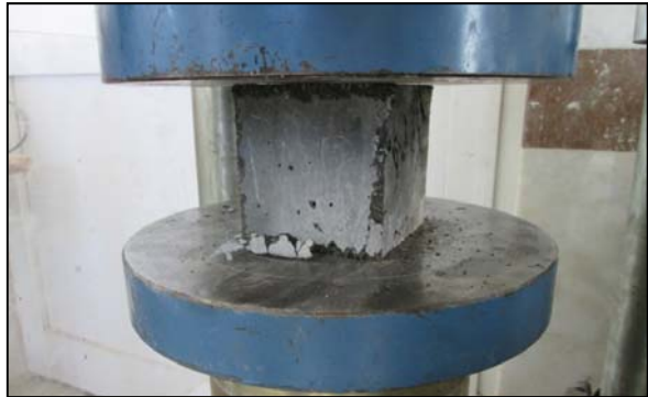
Şekil 2.5. Basınç dayanımı testi (Compressive strength test)
