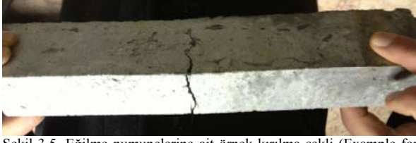
Şekil 3.5. Eğilme numunelerine ait örnek kırılma şekli (Example for flexure strength test)
