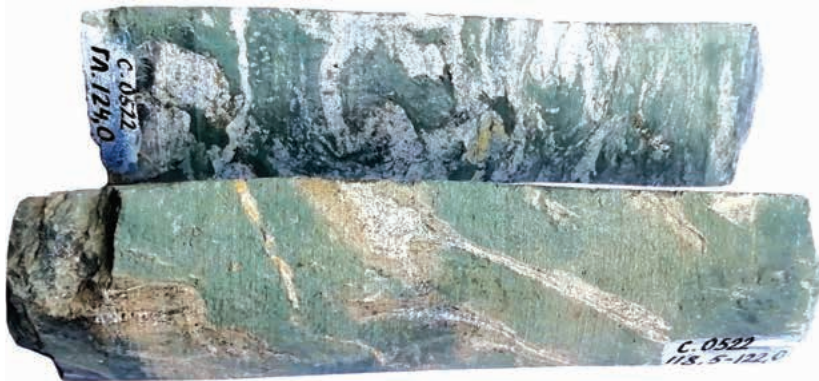
Рис. 4. Зразки молібденової руди родовища Балка Золота в метабазальтах у чвертинах розрізаного вздовж керна діаметром 76 мм зі св. 0522. Верхній зразок відібраний з гл. 124,0 м — звивисті кварцові прожилки з сульфідами (молібденіт, пірит); нижній зразок із рудної зони 118,5—122,0 м — кварц-карбонатні прожилки з сульфідами
