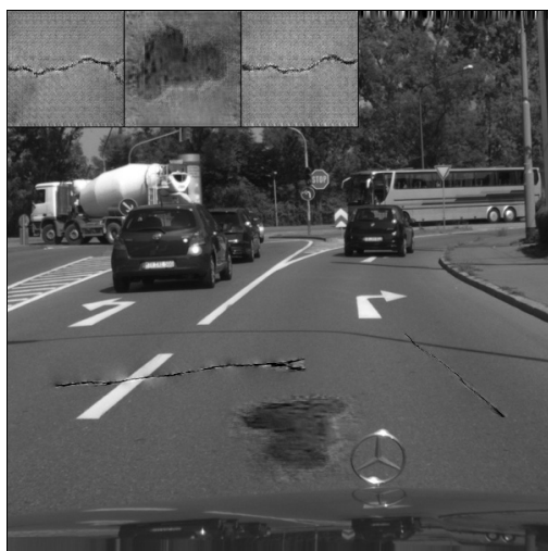
Рис. 8. Результат аппликации дефектов, сгенерированных с помощью DCGAN
