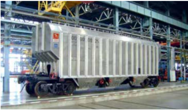
Рис. 4. Вагон-хоппер с кузовом из алюминиевого сплава 1565Ч
