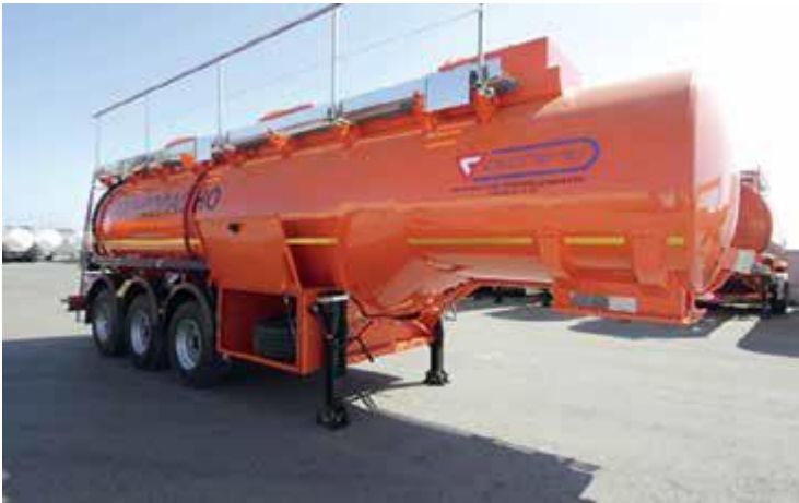
Рис. 5. Автоцистерна для перевозки азотной кислоты из сплава АД0
