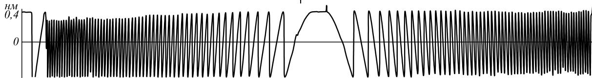
Рис. 3. Профилограмма дифракционной линзы с высотой микрорельефа 7,5 мкм
