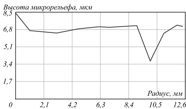
Рис. 4. Зависимость высоты микрорельефа от радиуса записи
