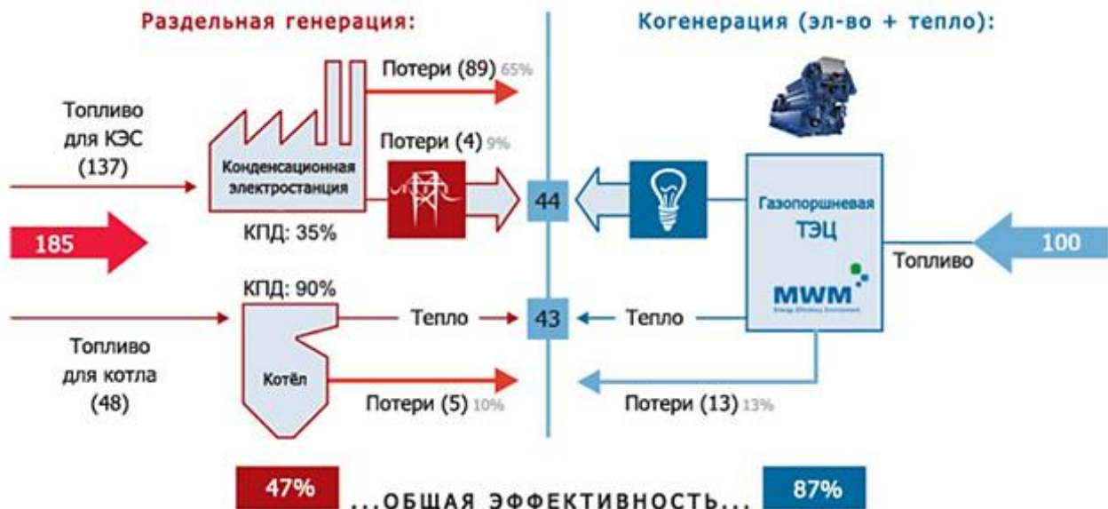
Рисунок 1 – Сравнение общих уровней эффективности при раздельной и комбинированной генерации (в условных единицах топлива)
