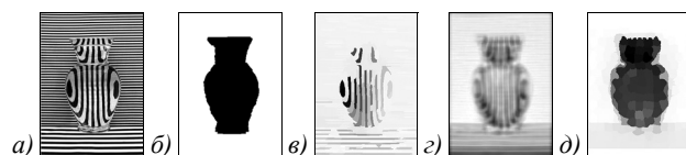
Рис. 2. Использование текстурных признаков для получения карт значимости: а) тестовое изображение из набора данных MSRA-1000, б) эталонная карта значимости тестового изображения, в) карта значимости, полученная на основе метода ранжирования вершин графа по цветовым признакам изображения [38], г) изображение, обработанное с использованием функции энергии Габора, д) карта значимости, полученная на основе метода ранжирования вершин графа по цветовым и текстурным признакам изображения
