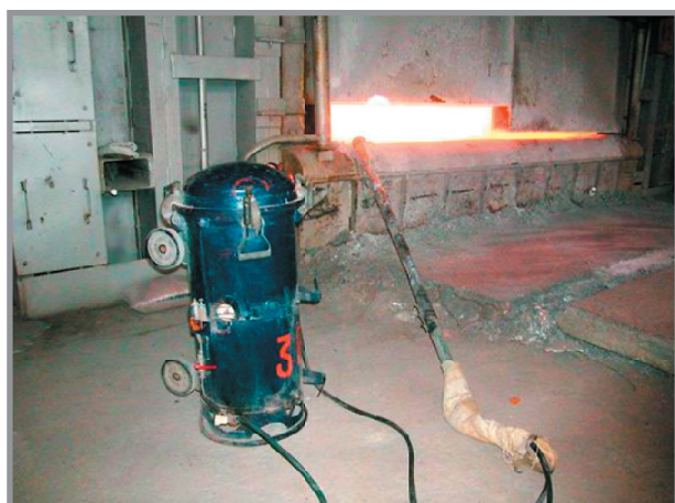
Рис. 2. Применение инъекционной технологии получения алюминиевых сплавов, содержащих скандий, и схема питателя технологического порошка на ОАО «КУМЗ»
