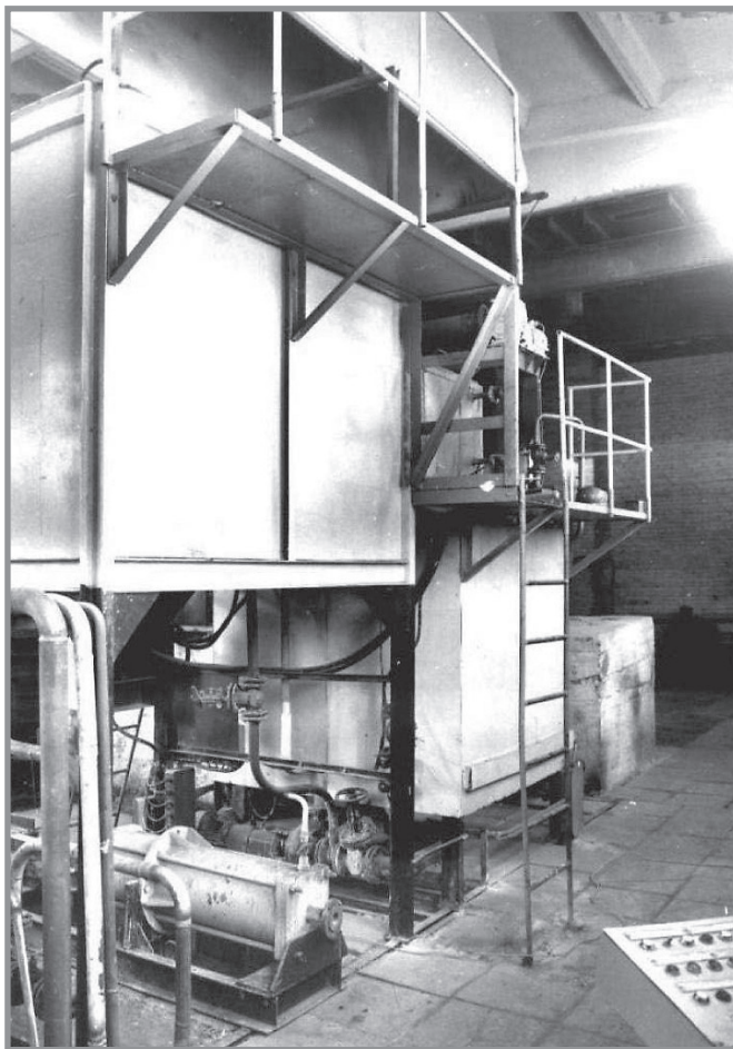
Рис. 2. Емкости с датчиками уровня для компонентов многотоннажных отходов: концентрата ЛСТ (СДБ) и сульфата натрия СН. Емкость готовой суперЛТМ объемом 4 кубометра, обеспечивающая производство 2000 кубометров особо долговечного и особо прочного бетона
