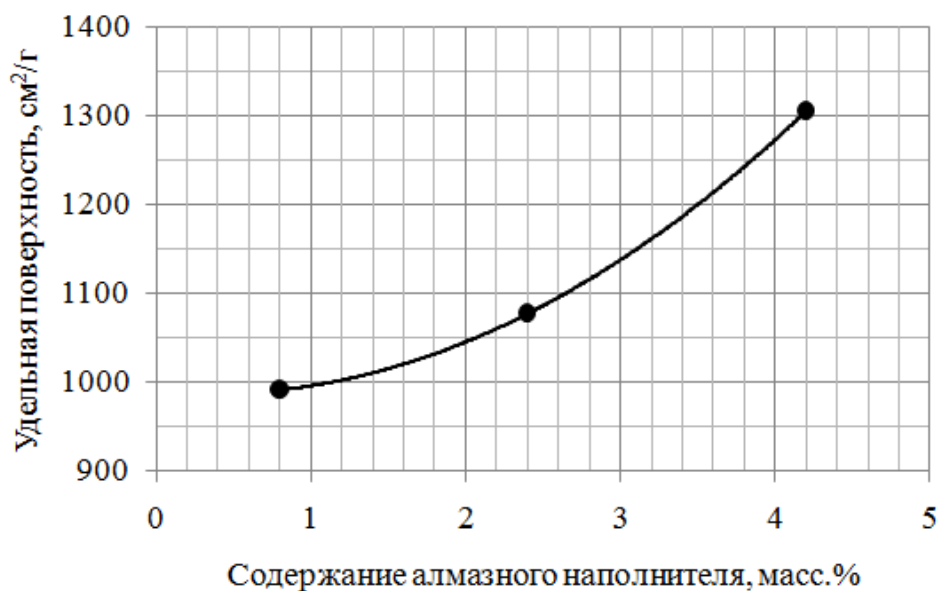
Рисунок 3 - Зависимость значения удельной поверхности от массового содержания алмазного наполнителя после смешивания в шаровой мельнице.
