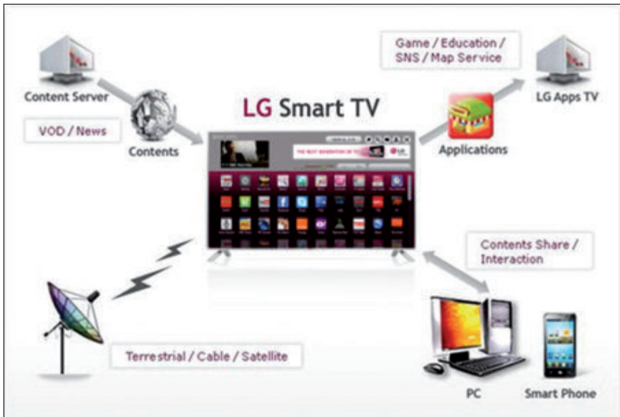
Figura 5. Esquema de funcionamiento de una aplicación para LG Smart TV.
