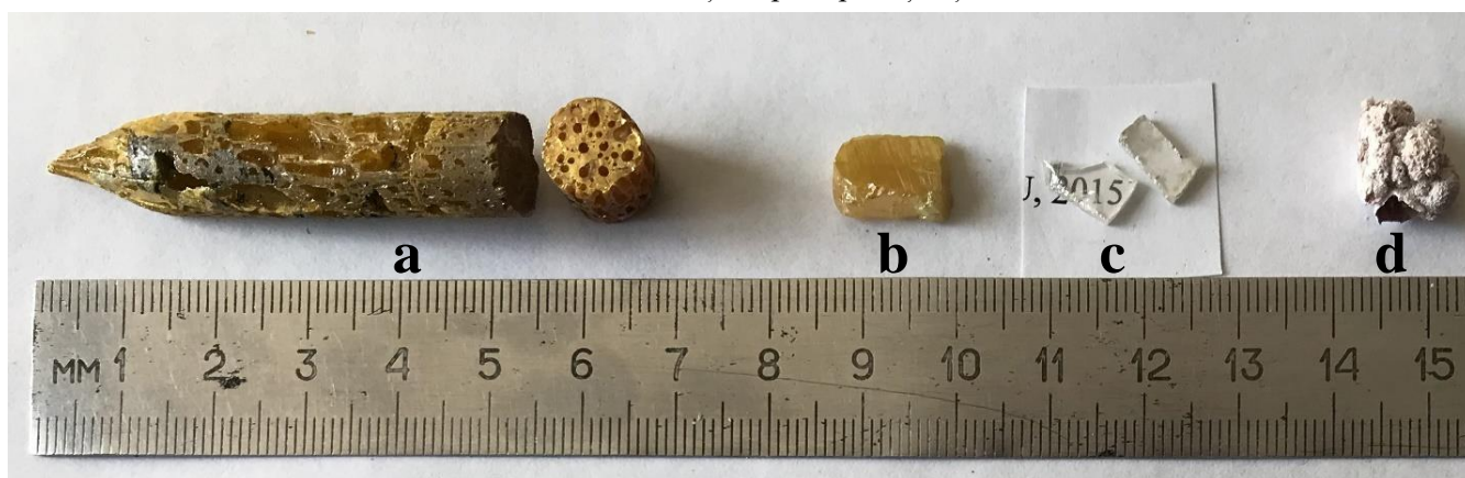
Fig.1. Lingou de \text{Ga}_2\text{S}_3 policristalin (a), monocristalul \text{Ga}_2\text{S}_3 crescut prin metoda Bridoman (b), prin transport în atmosferă de \text{I}_2 (CVD) (c) și materialul compozit \text{Ga}_2\text{O}_3 - \text{Ga}_2\text{S}_3 obținut la temperatura de călire a cristalelor de \text{Ga}_2\text{S}_3 (1173 K) timp de 6 ore (d).
