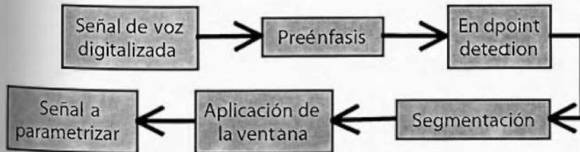
Figura 3. Esquema de pre-procesamiento de la señal de voz
