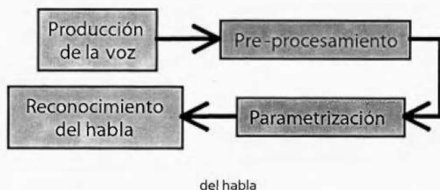
Figura 2. Esquema de procesamiento de la voz para el reconocimiento
