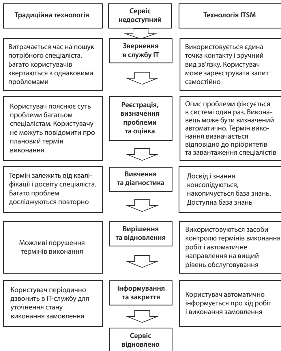
Рис. 1. Основні переваги та відмінності в роботі служби технічної підтримки, побудованої за стандартами ITSM, порівняно з традиційними підходами
