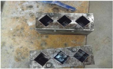
*Plate 1:*  $50 \text{ mm} \times 50 \text{ mmmoulds}$
