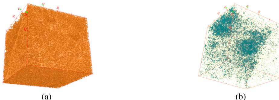
Figura 1. Imagem em 3D do espaço poroso inter-agregados e intra-agregados do Neossolo Regolítico Eutrófico (a-b).
