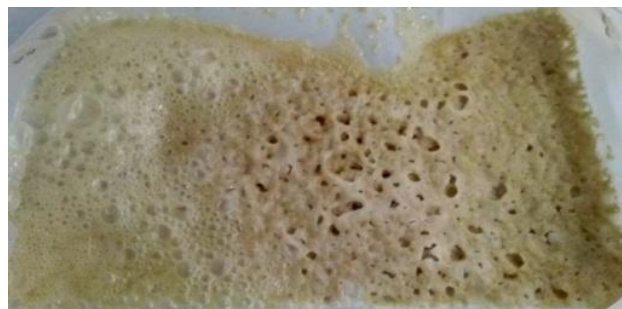
Рисунок 2. Состояние отходов связующих ЭДТ-10П и УП-2217 в присутствии крахмала и ортофосфорной кислоты
