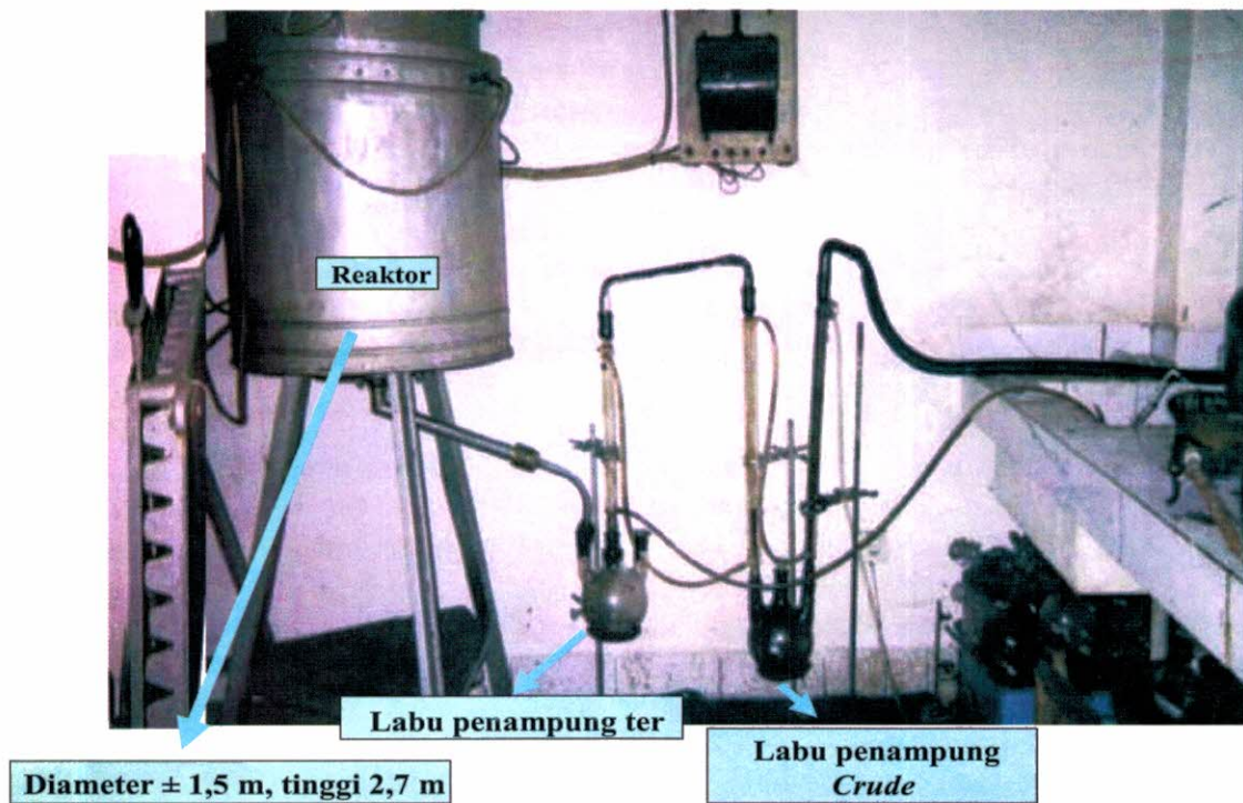
Gambar 1. Pirolisator yang terdapat di Pusat Penelitian dan Pengembangan Keteknikan Kehutanan dan Pengolahan Hasil Hutan Bogor
