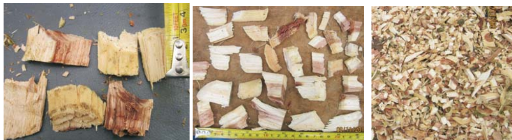
Gambar 2. Produk hasil perserpihan dari pembuat serpih tipe-2 Figure 2. Product of chips by chipper type-2
