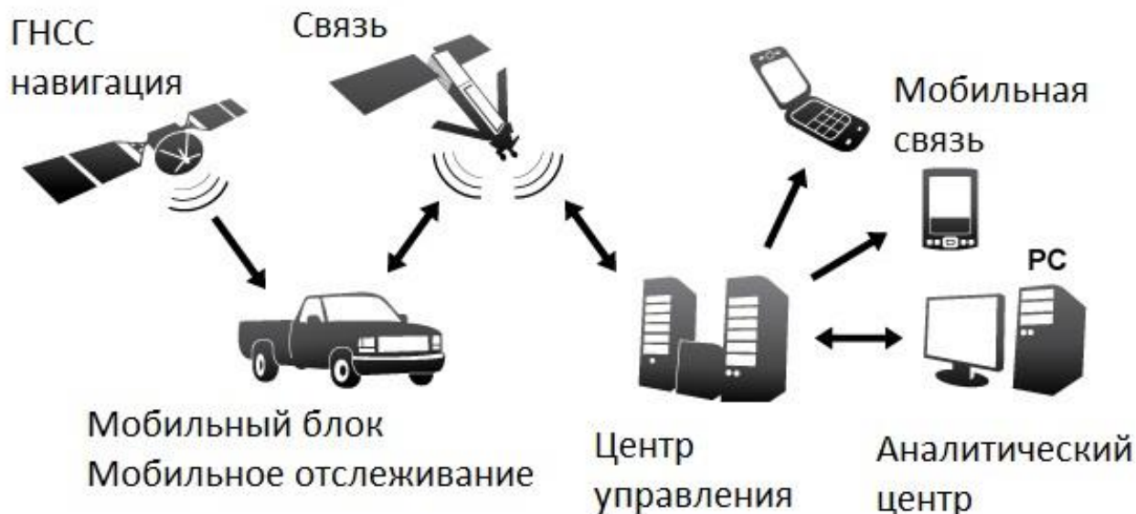
Рис. 4. Спутниковая схема управления автодорожным транспортом
