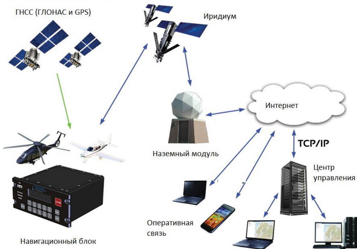
Рис. 3. Спутниковая схема управления воздушным транспортом.
