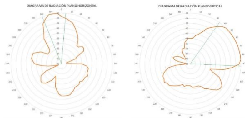
Figura 7. Diagrama de radiación en el plano Horizontal y Vertical en los puntos de media potencia
