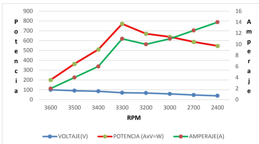
**Figura 3.** Resultados de prueba del motor monocilindro con ingreso de H<sub>2</sub> en el dinamómetro.
