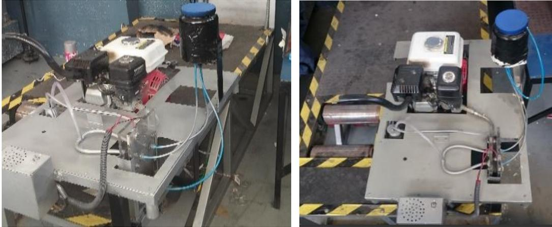
**Figura 1.** Generador de hidrógeno sobre el banco dinámometro para medición de potencia.
