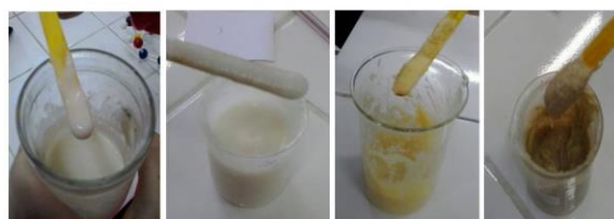
Figura 6: Foto das colas produzidas pelos estudantes, com farinhas de: trigo, arroz, milho e aveia, respectivamente.
