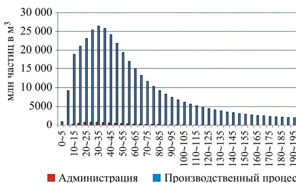
Рис. Сравнительная оценка концентрации наночастиц при производственном процессе и в воздухе административного помещения
