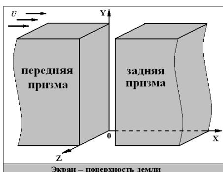
Рис. 5. Схема обтекания призм без перекрытия
