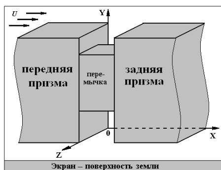
Рис. 9. Схема обтекания призм с перемычкой
