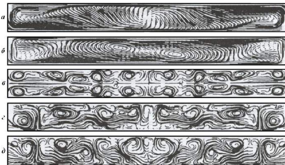
**Рис. 4. Образование вихрей Тейлора-Гертлера
