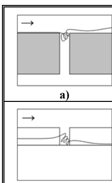
Рис. 7. Вихрь в верхней части межторцевого пространства над задней призмой
