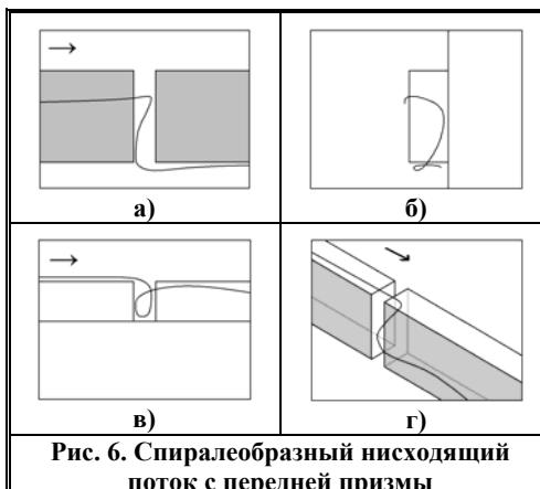
Рис. 6. Спиралеобразный нисходящий поток с передней призмой
