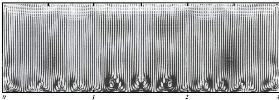
Рис. 2. Зарождение вихрей Тейлора-Гертлера
