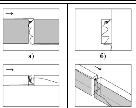
Рис. 8. Течение из центральной области вихря в верхней части межторцевого пространства под задней призмой
