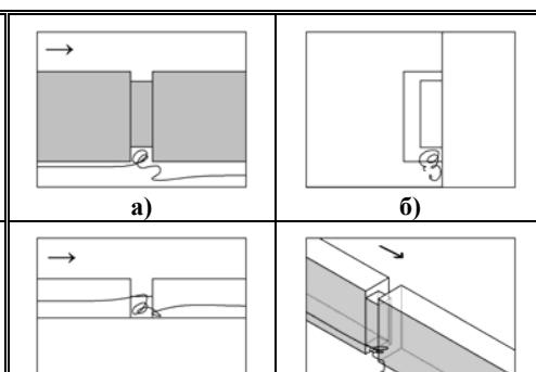
Рис. 12. Спиральная структура под нижней гранью перемычки
