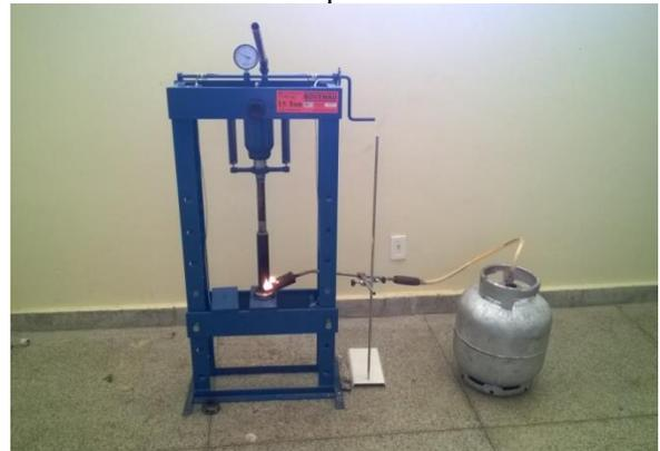
Antes da confecção propriamente dita dos briquetes, realizaram-se vários testes em relação à pressão a ser utilizada, granulometria e massa da serragem, tempo e temperatura, visando a obtenção de um briquete de qualidade.
