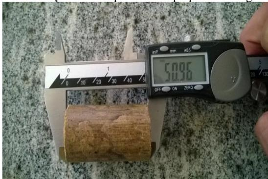
Determinou-se também a densidade a granel. Tendo em vista a pequena quantidade de briquetes produzidos, fizeram-se adaptações (150 x 150 x 150 mm) na norma NBR 6922 (ABNT, 1981) para determinar a densidade a granel.
