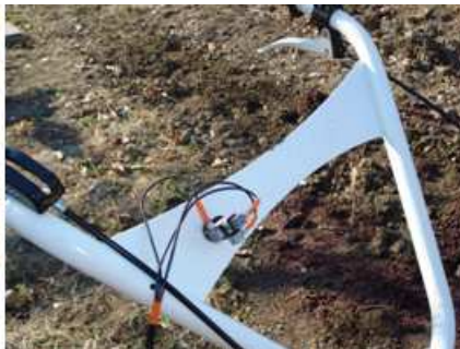
Fig. 5 - Position of the second accelerometer / Pozitia celui de-al doilea accelerometru
