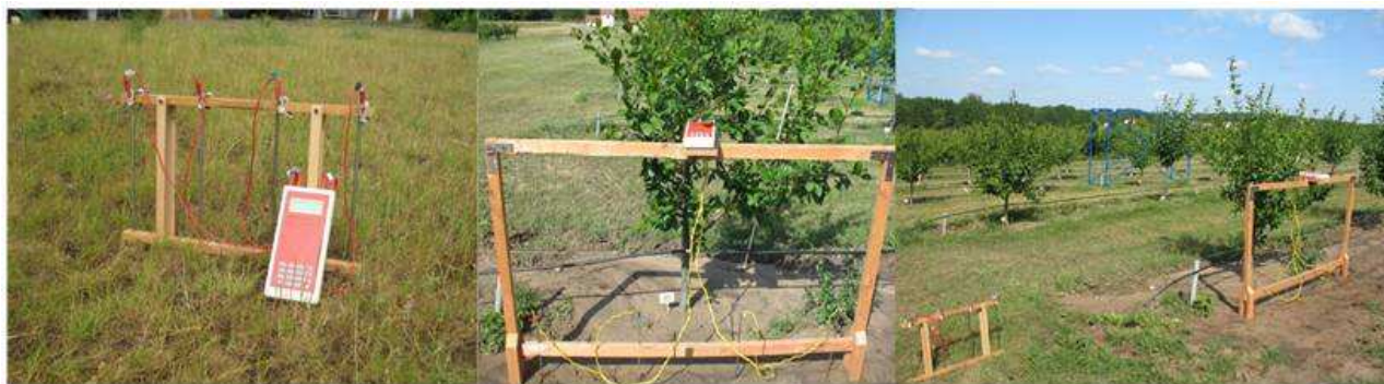
Fig.1 – Combined view of the 4 point light EC measurement device / Vedere combinată a aparatului de măsură a electroconductivității de tip 4 point light
