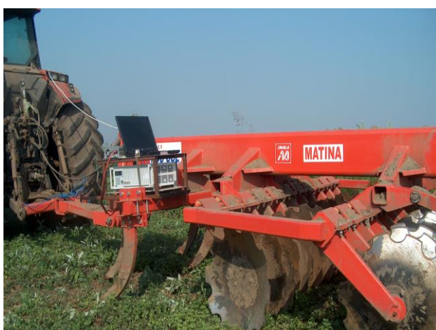
Fig. 5 - Image during determining the traction force - Traction diagram of MATINA aggregate / Aspect din timpul determinării forței de tracțiune/ Diagrama de tracțiune a agregatului MATINA
